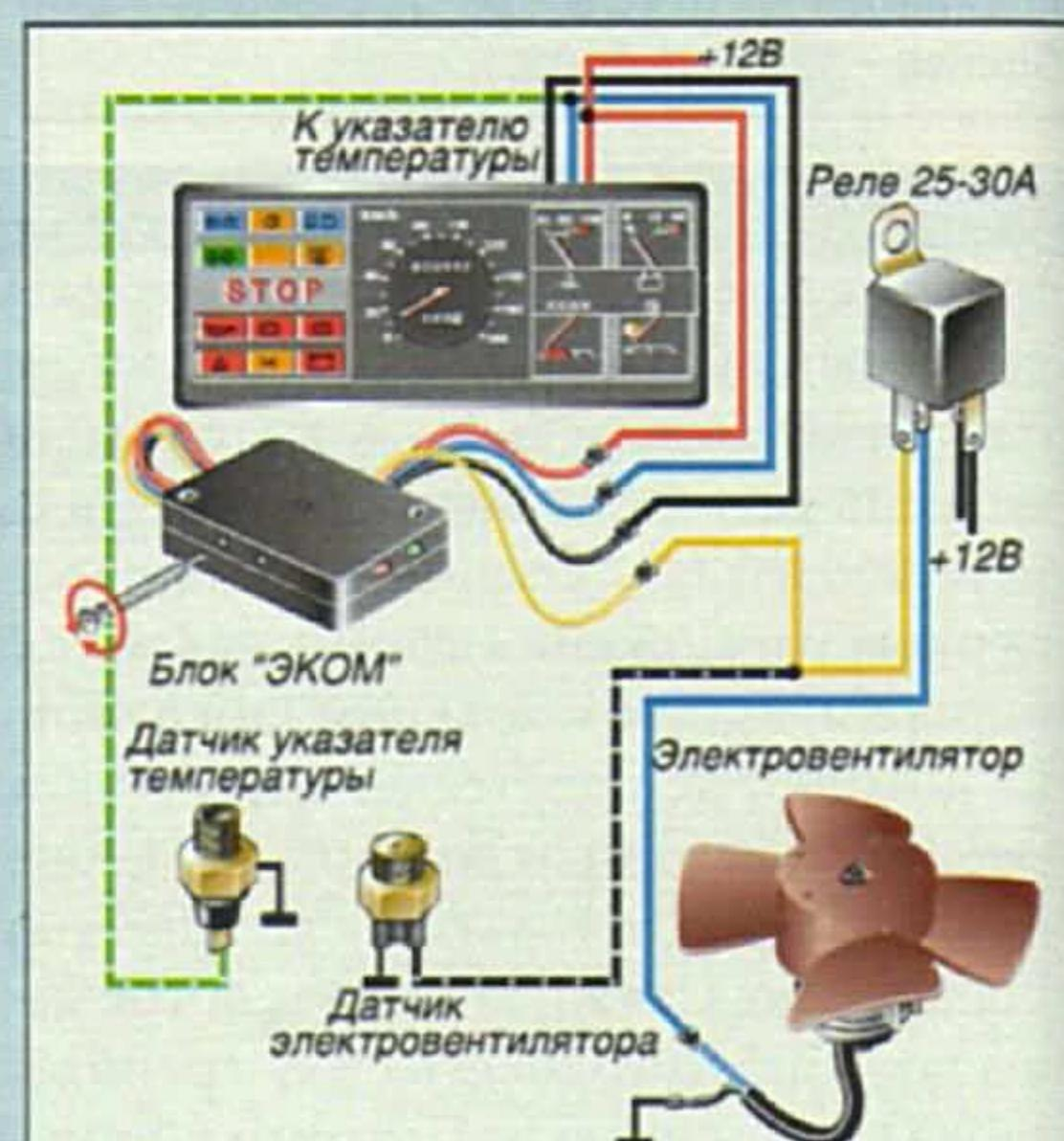
Подключение электронного блока для управления вентилятором.
